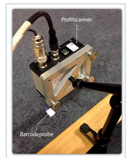
**Bild 2.** Messaufbau zur Erfassung der Probenprofile © Alexander Bauer
